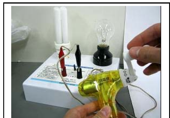
蛍光灯・白熱電球比較実験機
