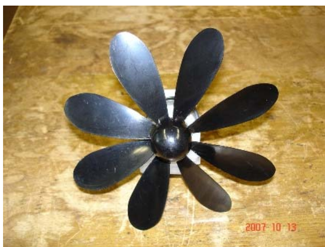
8枚ばねとそれを使った風力発電 (電子オルゴール使用)
