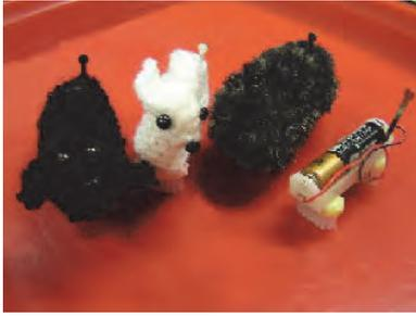
携帯電話用振動モータ(Vibration Motor-CM05J)を使用。振動ワンちゃん(プードルとチワワ&モグラ?)にバージョンアップ。
