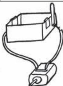
1. 電池ボックスにモータを取り付ける。
