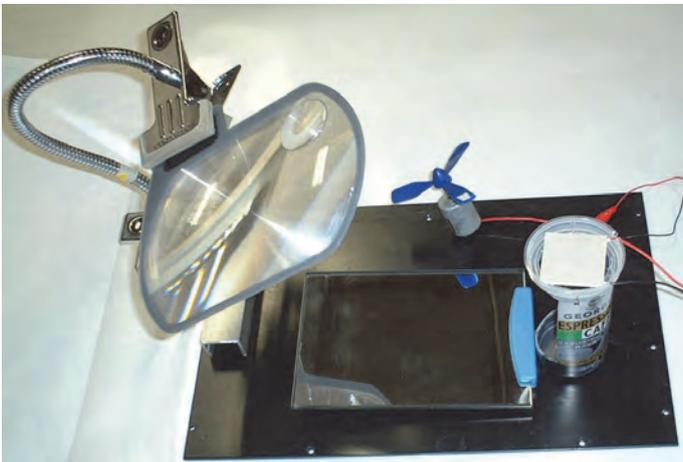
温度差があると発電するペルチエ素子という部品に、太陽の光をレンズで集めて熱すると電気を取り出すことができます。
